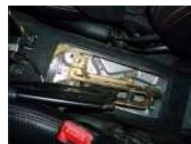
Avec la clé Allen de 8, on défait les deux vis et on détache le mécanisme de la coque... Les câbles sortent alors tout seul sans forcer du mécanisme...
