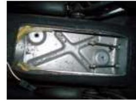
Les deux câbles sont maintenus par des agrafes au niveau des trous... On les enlève...
