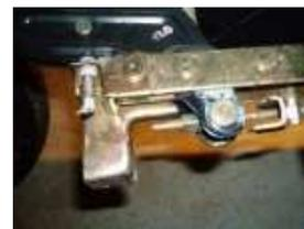
Gros plan sur la vis de réglage... un écrou antérieur et un postérieur...
