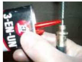
Il faut huiler le câble... ET on imprime un mouvement de va et vient jusqu'à ce que l'huile atteigne l'autre extrémité...
