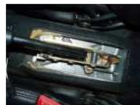
On soulève le bloc du rangement central et on le pose sur le siège passager... Pas la peine de défaire le câblage électrique de l'allume cigare car il est assez long... On accède ainsi au mécanisme du levier de vitesse et aux portions antérieures des câbles...
