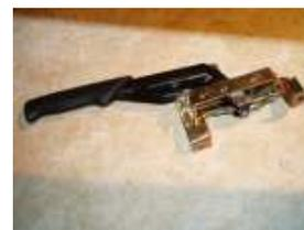
Le mécanisme enlevé : On distingue la longue tige de réglage..
